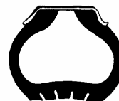
FALTA DE PRESSÃO
