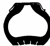
Falta de pressão
