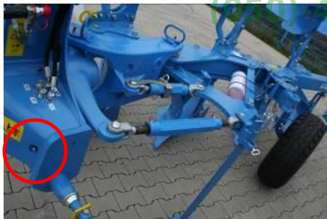
Кнопка на башне отпадает
